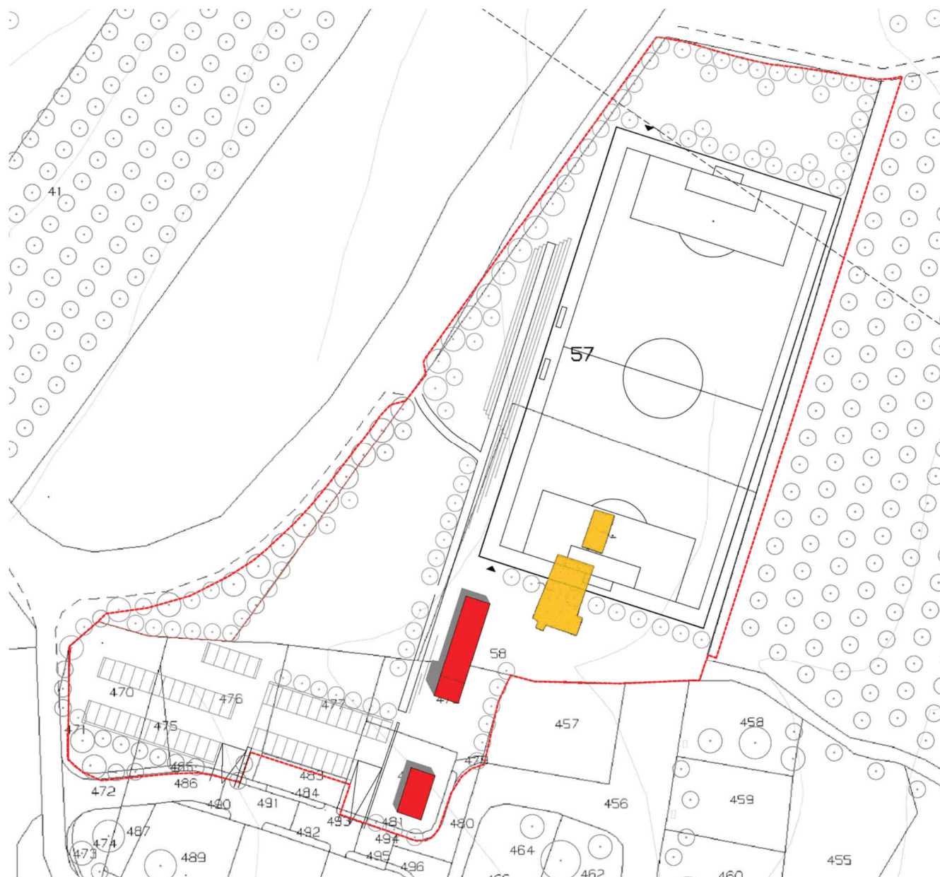
Figura D-3: Tavola 07 planimetria di progetto con sovrapposizione particelle catastali e indicazione di nuovi edifici (in rosso) e demolizione (in giallo)
